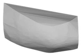
Cálculo do volume do contorno convexo da superfície = volume interno em mm3
